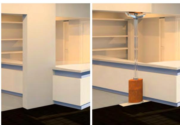
Figuur 3: Glazen kolom, kantoor ABT Velp, bestaand en nieuw (ontwerp)
